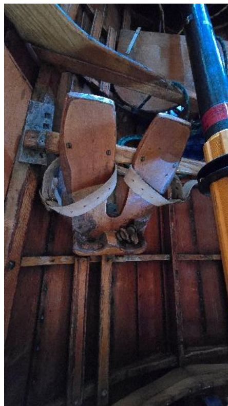
Bundpropper i fodspark nærmest styrmandssædet
